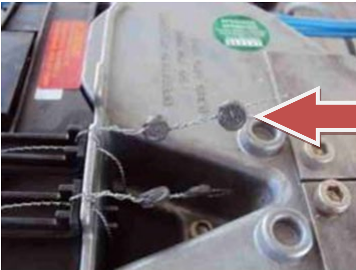
sigilli metrici sul taratore (particolare)
