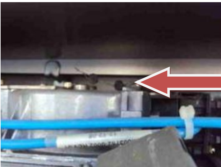
Sigillo metrico del manutentore (particolare)
