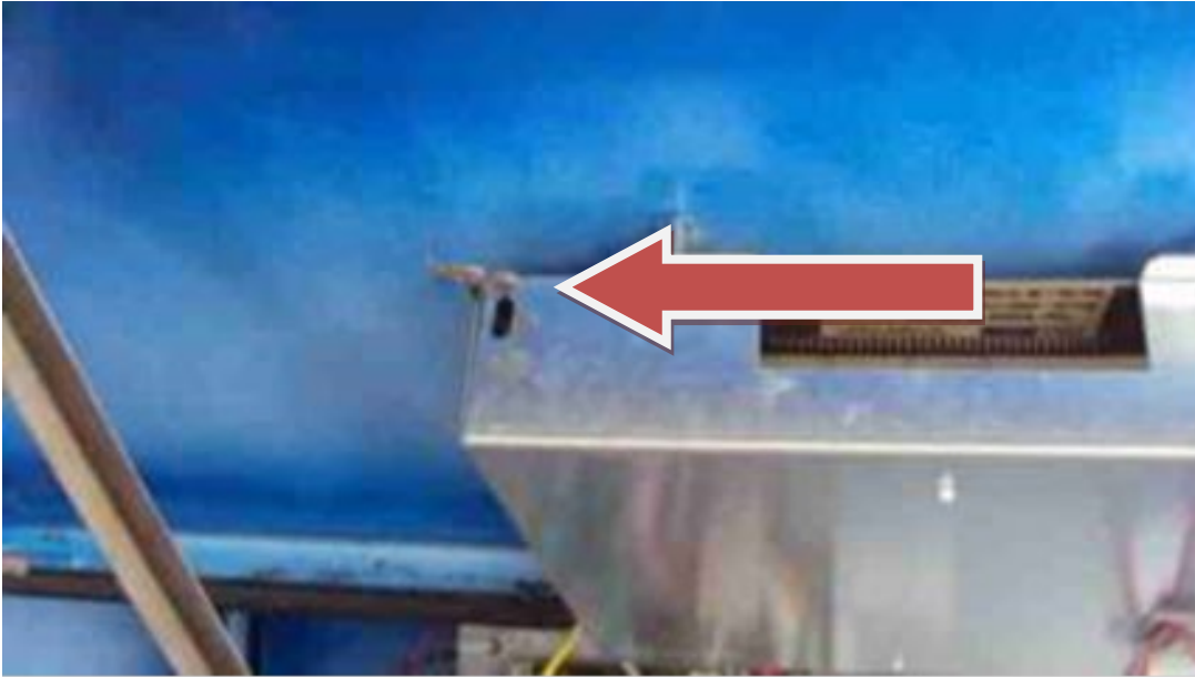
Sigilli sulla scheda elettronica della testata
